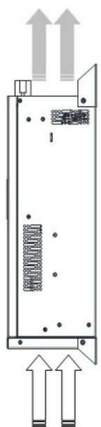
Rys. 3.2 Przepływ powietrza przez urządzenie.
